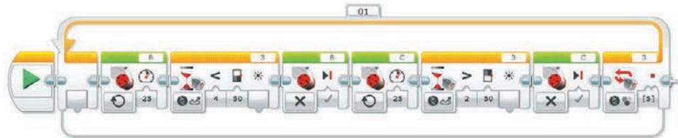
Pour que le robot s'arrête devant le drapeau, on peut programmer la boucle pour qu'elle se répète jusqu'à ce que le robot voit du rouge.
