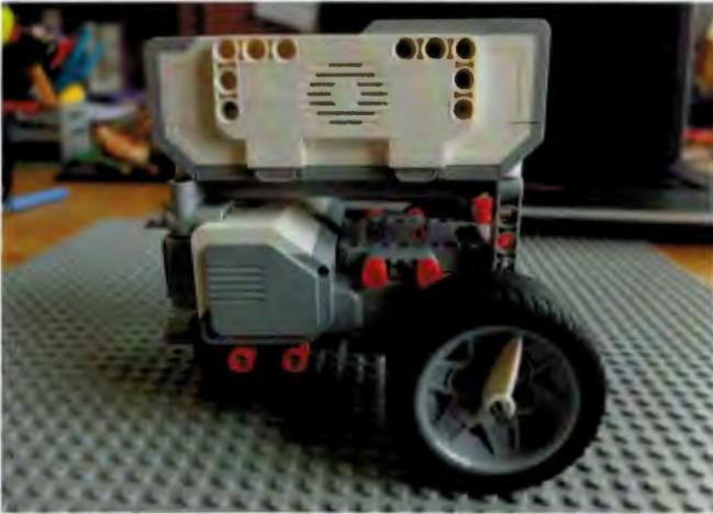
Pour le câblage, reliez le moteur gauche au port B et le moteur droit au port C.
