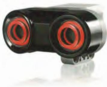
Le capteur à ultrasons permet de détecter des objets ou des obstacles. Il possède 2 orifices : un émetteur d'ultrasons, et un récepteur. À la manière d'un sonar, le capteur émet continuellement des **ultrasons** et capte leur écho lorsqu'ils se réfléchissent sur des objets distants. Le robot est alors capable de calculer le temps mis par l'écho pour lui parvenir, et ainsi en déduire la distance des objets.
