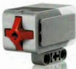
Le capteur tactile fonctionne à la manière d'un interrupteur. C'est le moyen le plus simple permettant au robot d'interagir avec l'environnement. Le robot pourra être programmé pour réagir différemment si le capteur est heurté, relâché ou maintenu appuyé.
