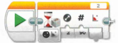
Dans ce cas, le capteur détectera un changement d'angle de  $90^\circ$ . C'est la première fois que l'on utilise l'option changement plutôt que comparaison. De ce fait, le robot détectera un changement de position de  $90^\circ$ , quelle que soit sa position initiale.
