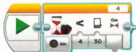
Les informations indiquées sur l'icône nous informent sur le port d'entrée (port 4 par défaut). Dans le cas présent, notre capteur détecterait un objet à une distance plus petite que 50 cm.
