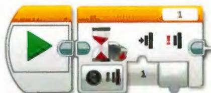
On peut alors définir sur quel port le capteur est branché (port 1 par défaut), et quel état du capteur le robot doit capter (0 : relâché, 1 : enfoncé, 2 : heurté).
