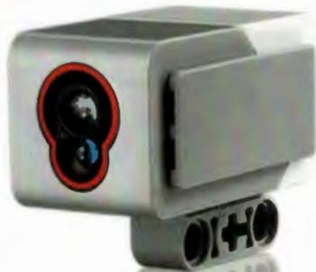
Le capteur de lumière permet de capter l'intensité lumineuse à proximité. Ainsi plus une surface sera éclairée, plus le signal reçu par le capteur sera élevé. Inversement, si la zone est sombre, le signal sera de faible intensité. Il est possible d'afficher l'intensité en pourcentage de lumière captée. En plein soleil, le capteur sature et affiche 100 %, alors que dans le noir total la valeur affichée est proche de 0 %.
