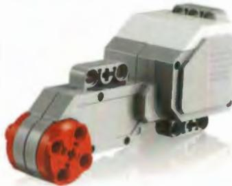
Sensibles au degré près, les servomoteurs sont équipés d'un tachymètre, permettant de compter les tours. Ils pourront être programmés pour effectuer des rotations, des angles, ou tourner de façon illimitée ou pendant un certain temps.
